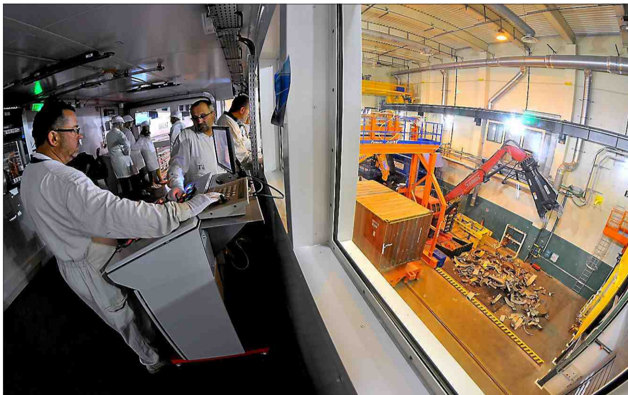
■ L'activité est pilotée depuis une salle de commande entièrement guidée de 80 tonnes de plomb.
